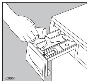
При необходимости, залейте кондиционер для белья в отсек, помеченный (не выше отметки "MAX" в лотке). Осторожно закройте дозатор моющих средств.
