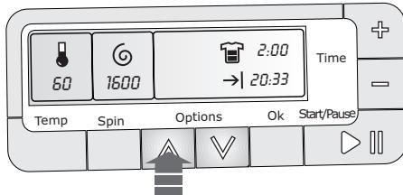
В зависимости от установленной программы доступны и отображаются на дисплее в процессе выбора только определенные опции.
